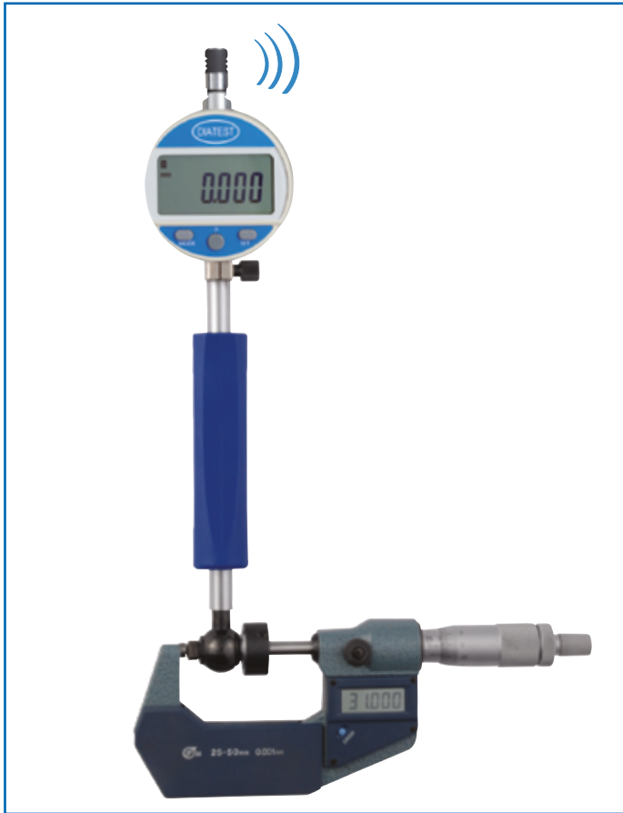
MK6 zur Nullstellung in Bügel-Messschraube Zero-setting of a MK6 in a micrometer
